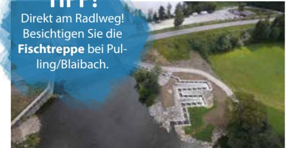
Die Fischwanderhilfe am Kraftwerk Pulling hat außergewöhnlichen Pilotcharakter für ganz Bayern, da das Bauwerk als so genannte große Talsperre (Stauvolumen, größer als eine Million Kubikmeter) und dessen 150 Meter langer Damm nun von der Fischtreppe durchquert wird. Die Fischwanderhilfe ermöglicht den Wasserlebewesen wieder ihre natürlichen Wanderbewegungen.
